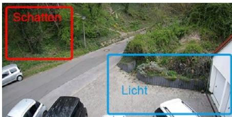
Details sowohl in dunklen als auch in hellen Bildbereichen kommen besser zur Geltung. Dadurch, dass die einzelnen Objektbereiche in einer Szene von der Kamera digital mit unterschiedlichen Helligkeits- beziehungsweise Gammawerten versehen werden, sind die Objekte in den hellen sowie in den dunklen Bereichen sichtbar.
