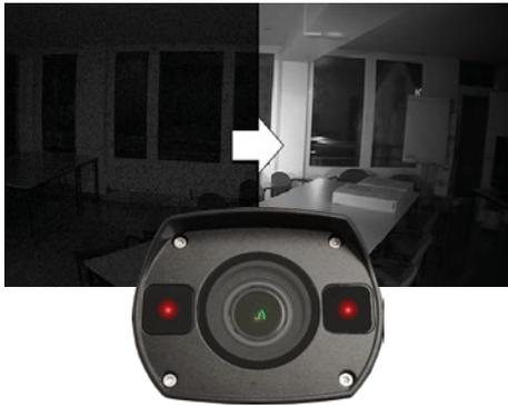
Bei schlechten Lichtbedingungen, zum Beispiel nachts, schaltet die Kamera automatisch in den Schwarz/Weiß-Betrieb um. Die Sicht wird zusätzlich durch die integrierte Infrarotbeleuchtung unterstützt. Die Kamera besitzt einen eingebauten Infrarot-Sperrfilter (IR-Cut-Filter). Damit werden störende Einflüsse der IR-Strahlung auf die Abbildungsqualität des Sensors vermieden.
